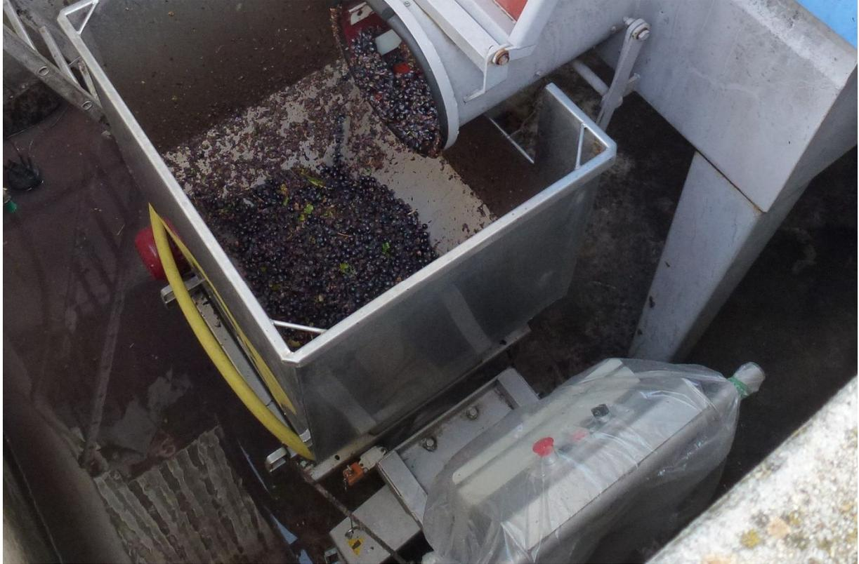
Le raisin coule dans le fouloir pour monter directement dans les cuves grâce à la pompe à marc qui se trouve au-dessous du fouloir.
